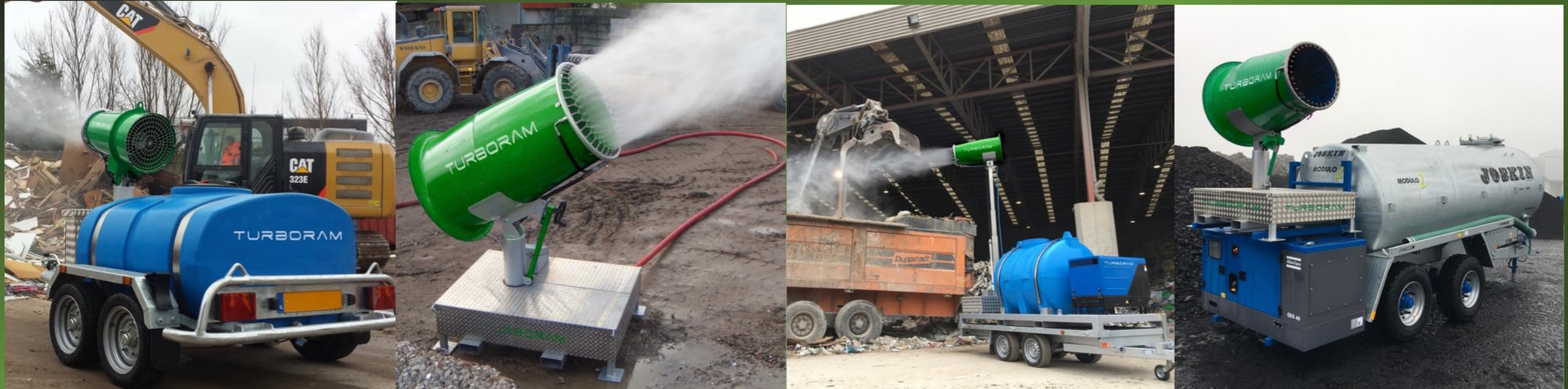
Les canons de brumisation TURBORAM sont utilisés pour la réduction des émissions de poussières et des odeurs sur les chantiers de démolition, mise au sol de vracs et pulvérulents, convoyage de solides, centre de tri, zones portuaires, carrières, mines, afin de protéger l'environnement et le personnel.
