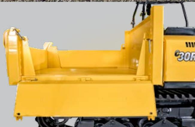
Benne à trois côtés avec déversement par l'arrière
