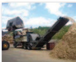
Des options intéressantes pour une conception individuelle de l'équipement : Convoyeurs de sorties longs ; aimant au-dessus du convoyeur pour trier le métal ; graissage centralisé.
