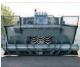
Système de rotor breveté. Pour un bon mélange et une grande aération
