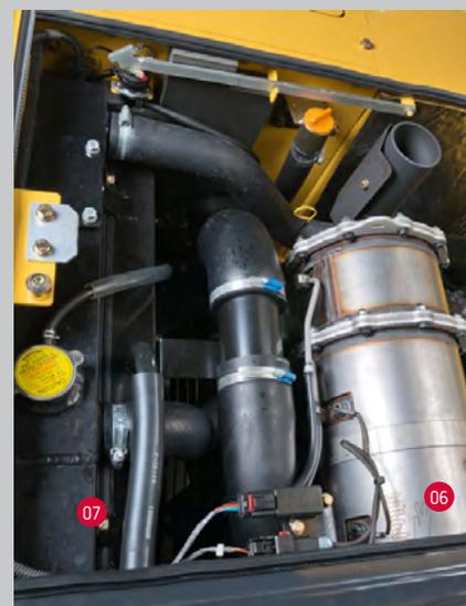
01 Filtre à air 02 Boîte à fusibles 03 Unité de commande du moteur 04 Batterie 05 Vase d'exp. du liquide de refroid. 06 FAP 07 Bouchon de radiateur
