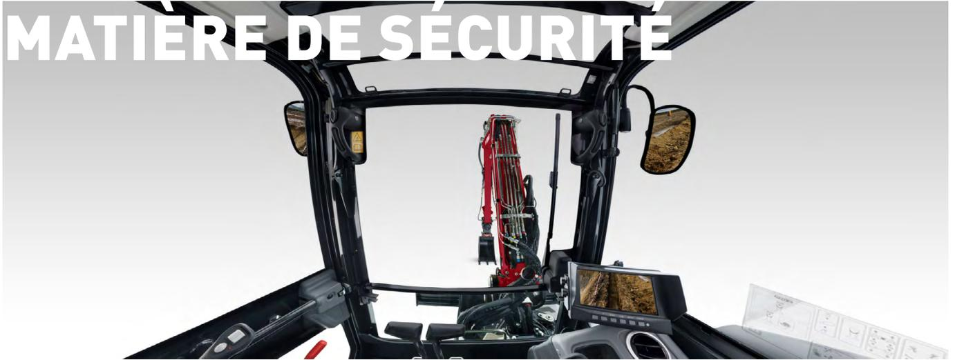
La cabine de la SV60-6B a été conçue pour répondre aux exigences de la certification ROPS (structure de protection contre le retournement) et du niveau 1 de la certification FOPS (structure de protection contre la chute d'objets). La cabine peut être équipée en option d'une protection FOPS de niveau 2 (protecteur avant et supérieur).
