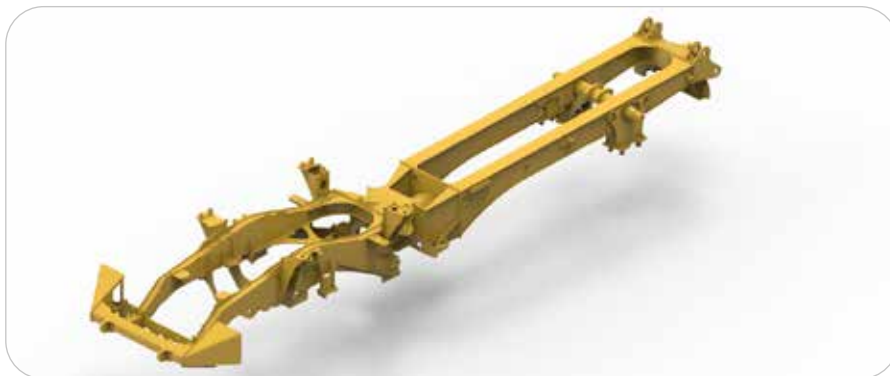
Le châssis en acier haute résistance procure robustesse et rigidité sans poids excessif.
