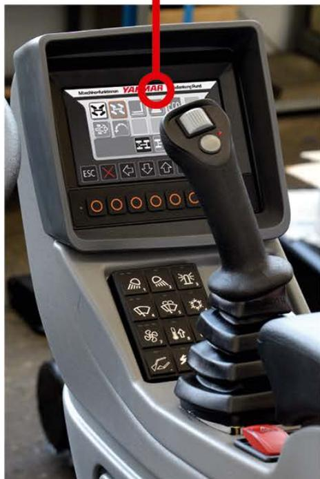
+ Commande rapide des circuits hydrauliques. Les volumes en litres des circuits de commandes sont adaptés, même en fonctionnement continu, de manière proportionnelle, via des diagrammes, selon les utilisations et outils installés.
